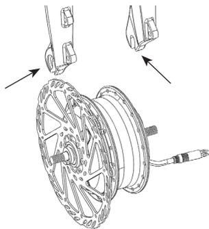
4. Fixer le contre-écrou borgne BC3/8 dans le sens des aiguilles d'une montre avec la clé à fourche aux deux extrémités du moteur. Couple de serrage requis : 30-36 N·m.
